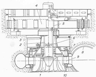
Bild 3. 500-MW-Turbosatz des Krasnojarsk-Kraftwerkes
