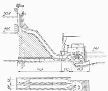
Bild 9. Querschnitt durch das Maschinenhaus des Kraftwerkes Krasnojarsk
