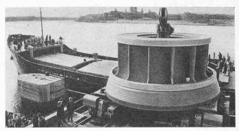
Bild 10. Verschiffung eines 500-MW-Turbinenläufers
