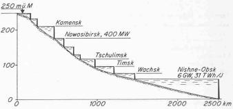
Bild 4. Die Kraftwerkskette auf der Angara
