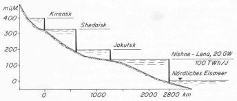
Bild 7. Eine Ausbauvariante der Lena
