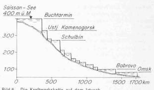
Bild 6. Die Kraftwerkskette auf dem Irtysch
