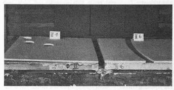
Bild 5. Ähnlicher Haftversuch wie in Bild 4 von Weissputz mit PVA-«Binder»-Zusatz nach Gebrauchsvorschrift. Bei diesem Produkt erfolgte Ablösung des Putzes bei geringster Beanspruchung
