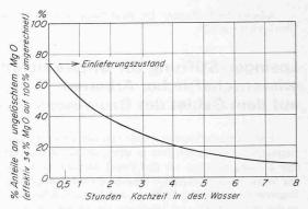
Bild 11. Hydratationsgeschwindigkeit des MgO-Anteils eines ungenügend gelöschten dolomitischen Weisskalkes in siedendem Wasser
