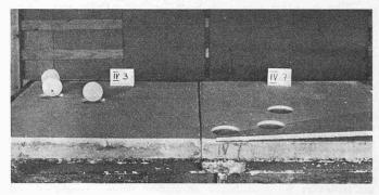
Bild 6. Haftversuch mit Fertigputzmischung: Vorzügliche Haftung. Beim Zugversuch erfolgt der Bruch in der Putzmasse, d. h. die Haftung am Beton ist stärker als die Kohäsion des Putzmörtels auch nach nochmaliger starker Durchfeuchtung
