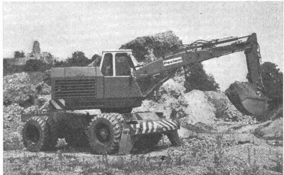
Die wichtigsten technischen Daten des Typs TY 2 P: luftgekühlter 4-Zylinder-Deutz-Dieselmotor 48 PS, Fahrgeschwindigkeit bis 12 km/h (5 Vorwärts- und 5 Rückwärtsgänge), äußerer Wenderadius 7,2 m, Steigungsfähigkeit 60 Prozent, Gewicht mit einer Ausrüstung rund 10,3 to, Ausrüstungen: Tiefloßel, Greifer, Ladeschaukel, Kranausleger, Kranhakenvorsatz, Hydraulikwinde, Güterumschlagausleger.
