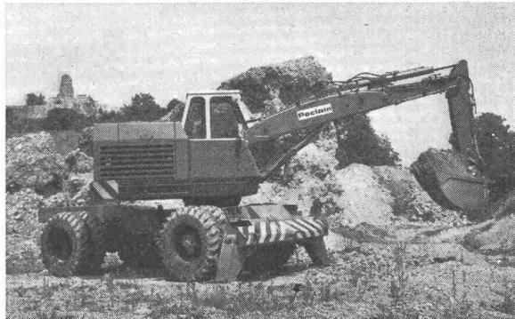
Die wichtigsten technischen Daten des Typs TY 2 P: luftgekühlter 4-Zylinder-Deutz-Dieselmotor 48 PS, Fahrgeschwindigkeit bis 12 km/h (5 Vorwärts- und 5 Rückwärtsgänge), äußerer Wenderadius 7,2 m, Steigungsfähigkeit 60 Prozent, Gewicht mit einer Ausrüstung rund 10,3 to, Ausrüstungen: Tiefloßel, Greifer, Ladeschaufeln, Kranausleger, Kranhakenvorsatz, Hydraulikwinde, Güterumschlagausleger.
