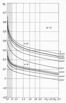
Bild 18. Eintrittswiderstände für dünne Filter, abhängig von der Schlitzbreite b und der Dicke d; n= 2 und 4,  $\varkappa=$  2, l=  $\infty$
