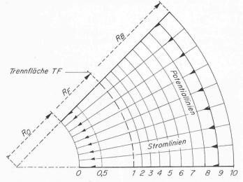
Bild 5. Radialströmung mit Fremdzone. Trennfläche senkrecht angeströmt
