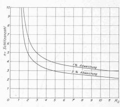
Bild 12. Abstand  $R_G$  bei verschiedener Schlitzreihenanzahl (gültig für 0,016 b= 0,200)
