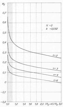
Bild 21. Eintrittswiderstände für dünne Filter, abhängig von der Schlitzreihenanzahl n und der Dicke  $d;\ b=$  0,032,  $\varkappa=$  2, l=  $\infty$
