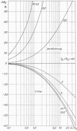
Bild 10. Prozentuale Änderung des Widerstandes bewirkt durch eine Fremdzone bei Einzeldrain mit Rohrwiderstand  $W_0=0$ . Abhängig von der Dicke d und der Durchlässigkeit  $\varkappa$
