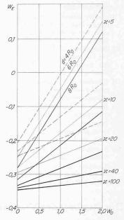
Bild 25. Eintrittswiderstände für dünne Filter mit (strichliert) und ohne Verdichtung, abhängig von der Filterdicke  $d_F=4,\ b=0.032\ R_0,$   $\varkappa_F=10,\ \varkappa_V=0.1$
