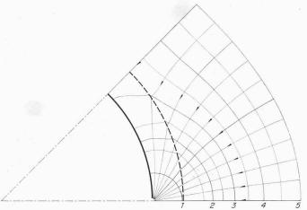
Bild 15. Strömungsbild zu einem geschlitzten Rohr mit dünnem Filter; n = 4, b = 0.032,  $d = 0.2 R_0$ , z = 10,  $l = \infty$
