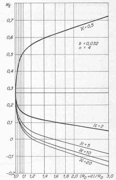
Bild 19. Eintrittswiderstände für dünne Fremdzonen, abhängig von der Durchlässigkeit  $\varkappa$  und der Dicke d; n= 4, b= 0,032,  $l=\infty$
