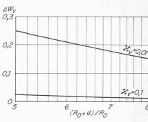
Bild 24. Zusätzliche Widerstände durch Verdichtung für zwei  $\varkappa_V$ -Werte als Funktion des Abstandes der Verdichtung vom Rohr,  $d_V=$  0,08  $R_0$
