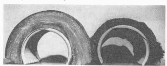
Da der Bereich um das Rohr auf Grund der geometrischen Verhältnisse hydraulisch entscheidend ist, beeinflusst jede Änderung in diesem Bereich die Zuströmung zum Rohr besonders stark. Zur Erhöhung der Durchlässigkeit und damit der Eintrittsleistung werden im Rohrbereich Filter aus Kies, Schlacke, Torf, Tannenreisig, Glaswolle, Glasvlies, Styromull usw. eingebaut (Bild 1). Bei unsorgfältiger Verlegung kann sogar eine Verdichtung und damit eine Verringerung der Durchlässigkeit auftreten.
