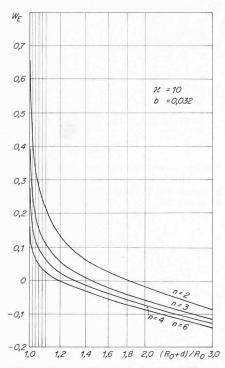
Bild 20. Eintrittswiderstände für dünne Filter, abhängig von der Schlitzreihenanzahl n und der Dicke  $d;\ b=$  0,032,  $\varkappa=$  10, l=  $\infty$
