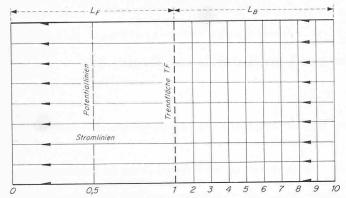
Bild 4. Parallelströmung mit Fremdzone. Trennfläche senkrecht angeströmt
