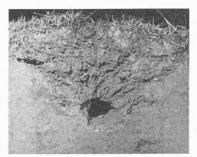
Bild 8. Maulwurfdrain, Querschnitt
