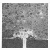
Bild 3. Mit Filter aus Glasvlies, 1,0 mm stark (heller Streifen)
