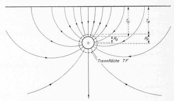
Bild 6. Strömung zu Einzeldrain mit Fremdzone. Trennfläche senkrecht angeströmt
