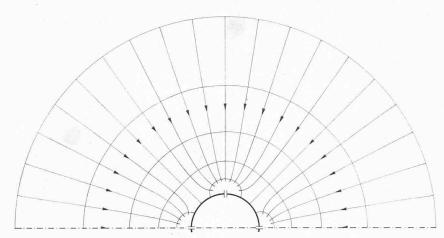
Bild 11. Zuströmung zu geschlitztem Rohr bei durchgehend gedachten Längsschlitzen
