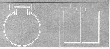
Sicherung von Behältern Etanchéïté de réservoirs Auskleidungen oder Aussenummantelungen aus Schwerfolien, zusammen mit IRONFLEX-Flüssigkeitssonden oder IRONFLEX-Vakuumkontrolle, sichern umfassend gegen Leckage.
