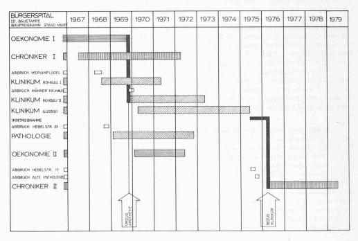
Bild 15. Im Mai 1967 ermitteltes Terminprogramm: Der Fertigstellungstermin aller Spitalbauten wird vor allem durch die mit einem Pfeil bezeichneten Abhängigkeiten beeinflusst. Die effektiven Bauzeiten der einzelnen Bauten liegen zwischen 31/2 und 71/2 Jahren. (Durch den Planungs- und Baustop wird sich naturgemäss eine Verschiebung dieser Termine ergeben.)
