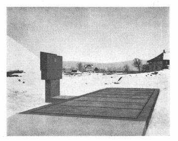
Brücke 10×2,8 m, Laufgewichtsbalken mit parallelgeschaltetem Messkopf
