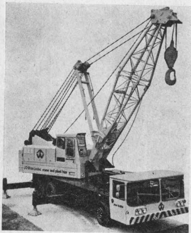
Bild 2. Coles-Autokran Typ « Illustrious », Tragkraft 40,8 t, maximale Auslegerlänge 54 m
