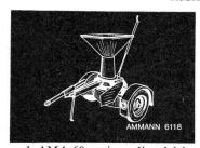
Bewährter Anhängestreuer zum Splitten vor die Hinterräder des Zugfahrzeuges oder zum Streuen von Salz nach hinten. Inhalt 0,2 m³. Streuteller und Rührwerk werden über ein Schaltgetriebe vom Fahrwerk aus angetrieben. Die Streudichte kann durch eine Dosierscheibe geregelt werden. AMA-6H, AMA-15, AMA-30
