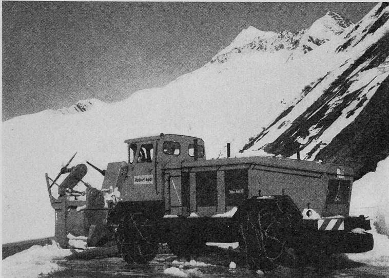
Bild 2. Frontansicht der Beilhack-Schneeschleuder Typ HS 292
