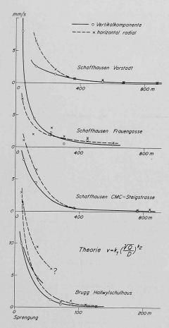
Bild 4. Abnahme der Erschütterungsintensität mit der Entfernung von der Sprengstelle
