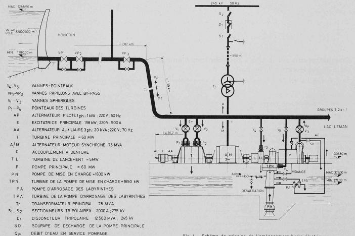
Fig. 1. Schéma de principe de l'aménagement hydro-électrique
