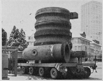
Fig. 6. Transport du corps de pompe entre deux ateliers d'usinage, à Winterthour. Poids de la pièce terminée: 80 t (Photo Sulzer Frères)
