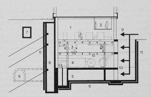
Bild 33. Schnitt 1:400 durch den Maschinensaal des Rechenzentrums.
