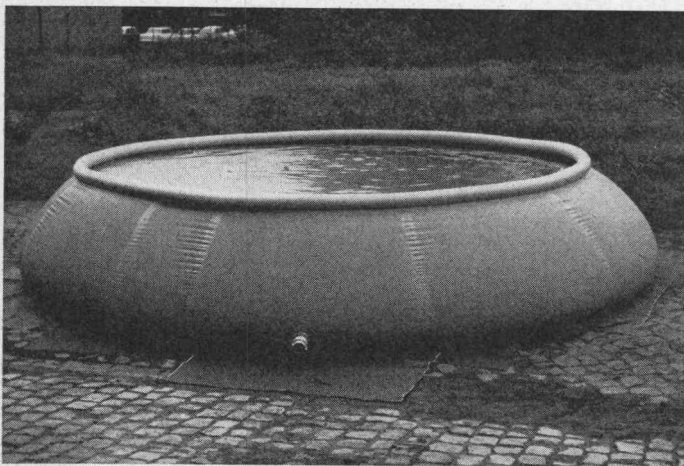
Bild 2. Offener EXCALOR-Fal behälter aus Neoprene/Hypalon-beschichtetem Polyestergewebe (Trevira), geeignet für Wasserspeicherung; Fassungsvermögen 10000 l.
