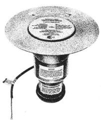
Gullykörper, Dampfsperre und die eingebaute Wärmedämmung bilden ein geschlossenes Bauelement — einfacher Einbau und kein Einbringen einer handgefertigten Wärmedämmung. Der Anschluss an der Dachhaut ist flexibel und absolut wasserdicht (patentierter Klemmring und mitgelieferte Rhepanolfolie).
