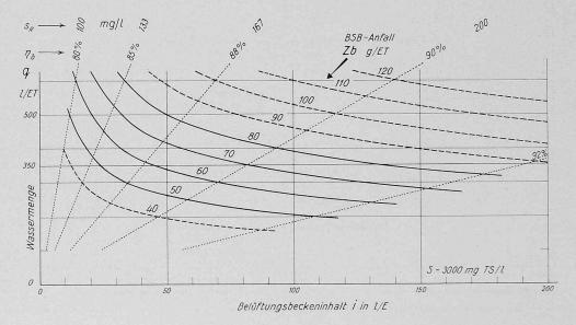
Bild 4. Erforderlicher Inhalt eines Belüftungsbeckens bei einer vorgeschriebenen Abflusskonzentration von 20 mg BSB/I und verschiedenen Annahmen für die Wassermenge q und den BSB-Anfall Zb. Schlammkonzentration S  $=3000\ \text{mg/I}$
