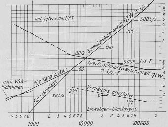
Bild 1. Der Trockenwetteranfall in Funktion der Zahl der angeschlossenen Einwohner (bei einem Jahresmittel von 350 I/ET)
