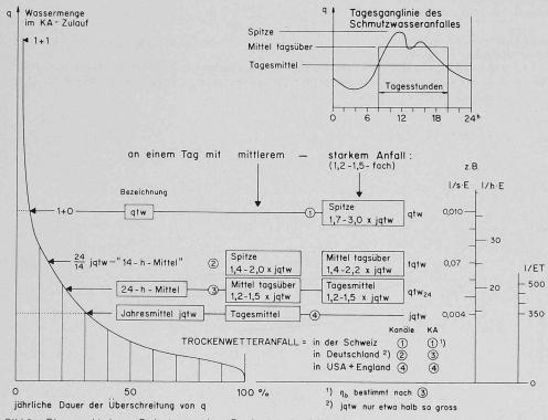
Bild 2. Die verschiedenen Bedeutungen des «Trockenwetteranfalles»
