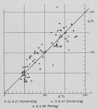
Bild 3. Die einzelnen Stundenmittel dreier Tage bezüglich BSB-Konzentration  $s_R$  und Wassermenge Q gemessen am arithmetischen Mittel jedes Tages (Ablauf der mechanischen Kläranlage Winterthur [61)
