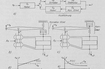
Bild 26. Dynamisches Verhalten eines Steuerschieber-Stellmotor-Systems mit nachgebender bzw. verzögerter Rückführung
