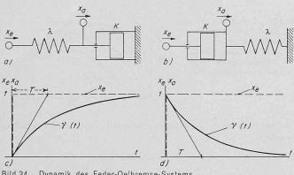
Bild 24. Dynamik des Feder-Oelbremse-Systems
