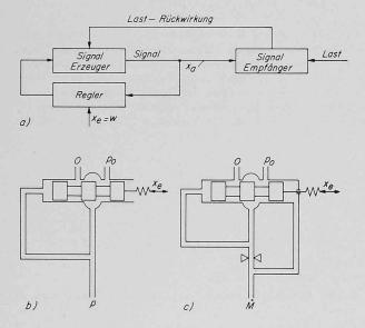
Bild 12. Erzeugung eingeprägter Druck- bzw. Stromsignale
