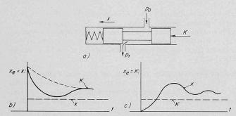
Bild 27. Dynamisches Verhalten eines Steuerschiebers
