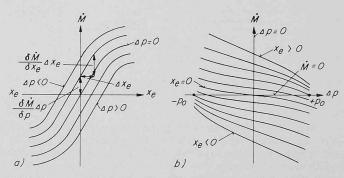
Bild 9. Kennlinienfelder eines hydraulischen Transmitters (Vierwegsteuerschieber) bei belastetem Signal
