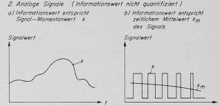
Bild 5. Uebersicht über in der hydraulischen Signaltechnik gebräuchliche Signaltypen
