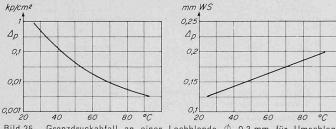
Grenzdruckabfall an einer Lochblende  $\phi$  0,3 mm für Umschlag von laminarer auf turbulente Durchströmung, links bei Oel, rechts bei Luft
