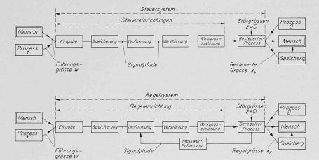
Bild 1. Allgemeines Blockschaltbild einer Steuerung Eingangsgrösse  $x_e =$  Führungsgrösse w; Ausgangsgrösse  $x_a =$  Gesteuerte Grösse  $x_s$
