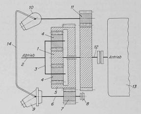
Bild 5. Planetengetriebe mit hydrostatischem Regelgetriebe zur stufenlosen Drehzahlveränderung
