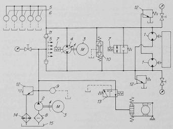
Bild 4. Hydrostatisch getriebener Bergbauhaspel
