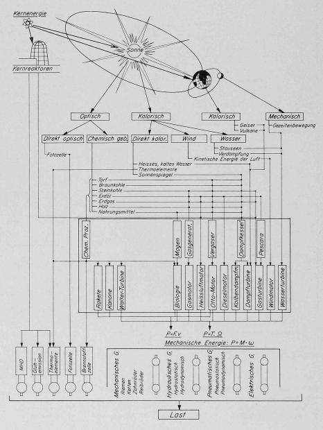
Bild 1. Energiequellen der Technik
