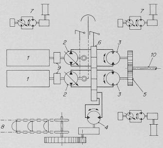
Bild 3. Hydraulische Anlage eines 900-PS-Eimerkettenbaggerschiffes
