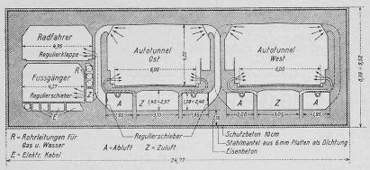
Bild 6. Querschnitt durch den Maastunnel in Rotterdam [16], 1:250
