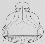
Bild 4. Vorschlag für die Querschnittsgestaltung eines querbelüfteten Kraftfahrzeugtunnels mit Lüftungsrichtung von oben nach unten.
