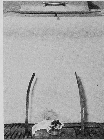
Bild 5a (links). Flammenbewegung bei Luftströmung von unten nach oben (Modellversuch)
