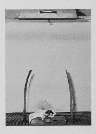
Bild 5b (rechts). Flammenbewe gung bei Luftströmung von oben nach unten (Modellversuch)
