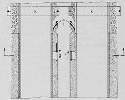
Bild 7. Vorschlag für die Gestaltung eines Kraftfahrzeugtunnels mit Sicherheitsvorrichtungen im Brandfall a Fahrraum, b Frischluftkanal, c Abluftkanal, d Fussgängertunnel, e Frischluftkanal zu d, f geschlossene Tür, g geöffnete Tür, h Seitentüren, i verschliessbares Portal, k Fussgängerunterführungen
