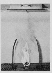
Bild 5a (links). Flammenbewegung bei Luftströmung von unten nach oben (Modellversuch)
