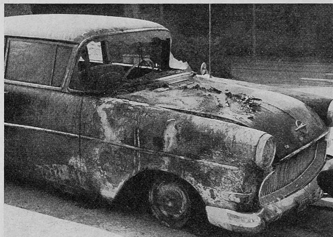
Bild 1. Durch Vergaserbrand im Wagenburgtunnel in Stuttgart beschädigter Personenwagen vor dem Tunnelportal
