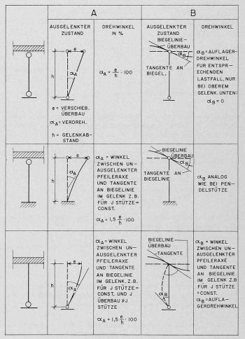
Bild 4. Berechnung der Gelenkverdrehungen bei den verschiedenen Stützensystemen infolge: A Längenänderung des Ueberbaus und B Durchbiegung des Ueberbaus
