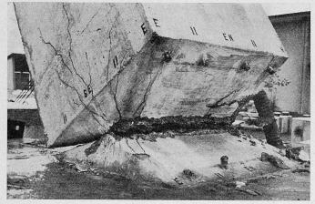
Bild 12. Das Gelenk bei maximal möglicher Auslenkung
