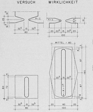
Bild 6. Gelenkabmessungen beim Versuch und in der Ausführung
