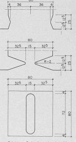
Bild 7. Gelenkpartie des Versuchskörpers
