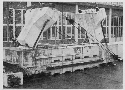
Bild 11. Maximale Auslenkversuche mit Seilzügen
