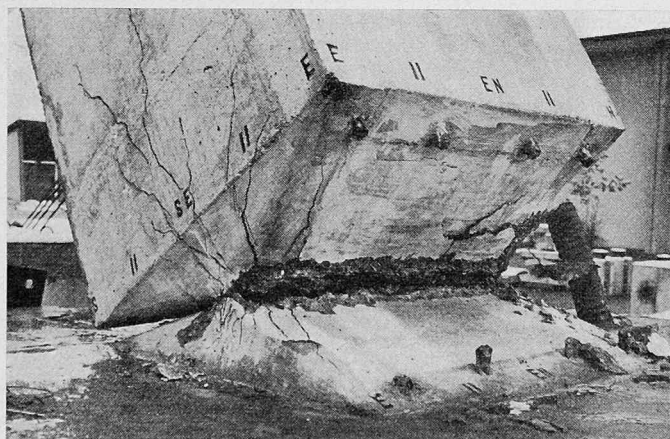
Bild 12. Das Gelenk bei maximal möglicher Auslenkung
