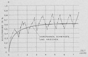
Bild 5. Gelenkverdrehung in Funktion der Zeit
