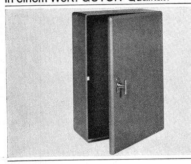
Alle Kasten sind aus formgepressten Stahlblech-Elementen zusammengebaut. Eine grosse Auswahl an Verschlußsystemen wie Riegel und Griff, Riegel und Steckschlüssel, Kaba-Zylinder usw. ermöglicht Ihnen in jedem Fall das passende einzusetzen. Der eingebrannte Hammerschlag-Effektlack garantiert einen dauerhaften Oberflächenschutz. Ein gut durchdachtes System an Einbauprofilen erleichtert den Einbau verschiedener Apparate.
