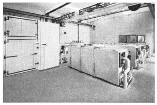
Beton-Frostanlage in der Empa
