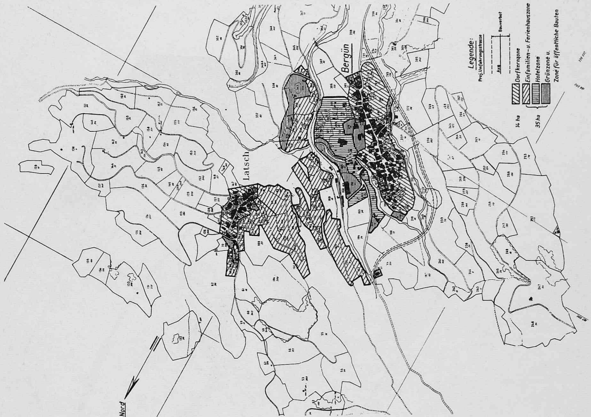
Bergün , Masstab rd. 1:20 000, Ortsplanung mit der Güterzusammenlegung bearbeitet, für die Ueberbauung und für die landwirtschaftliche Nutzung ist der geeignete Boden zugewiesen worden. Die Bauzonengrösse und die Erschliessungskosten bleiben in vernünftigen und tragbarem Rahmen
