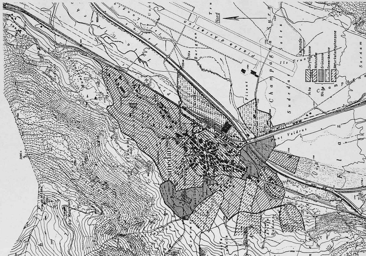
Samedan, Masstab rd. 1:20 000, Ortsplanung vor der Güterzusammenlegung bearbeitet, führt zu grossen Bauzonen mit grossen Erschliessungskosten
