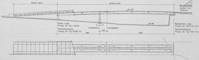
Bild 2. Längsschnitt und Grundriss der Brücke 1:500
