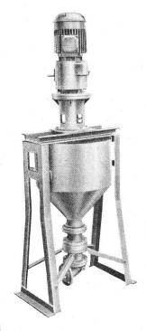
Auf Bild Spezialpumpe für Mörtel, Pressbeton, Bentonit, Zementbrei.
