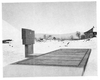
Brücke 10×2,8 m, Laufgewichtsbalken mit parallelgeschaltetem Messkopf
