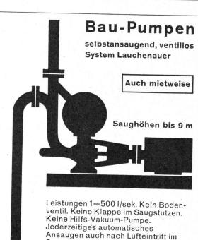
Ansaugen auch nach Lufteintritt im Saugrohr. Keine reibenden, sich abnützenden Dichtungsflächen, daher störungsfrei auch bei Schlamm-, Sand- und Kiesförderung.
