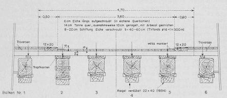
Bild 19. Wangen: Querschnitt 1:60 von Tragkonstruktion (Längsbalken) und Fahrbahn
