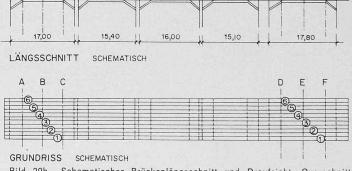
Bild 29b. Schematischer Brückenlängsschnitt und Draufsicht, Querschnitt mit Achse des Belastungsfahrzeuges
