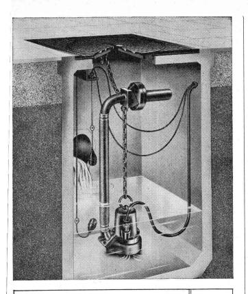
Vertikale Abwassertauchpumpe Robot Modell RW
