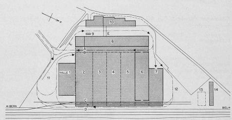
Lageplan. Legende: 1 Abbiegerei; Hallen, 2—4 Stahllager, 5 Röhren und Bleche, 6 Bleche, 7 Spezialartikel; 8 Warenlager in drei Geschossen mit Spedition, Kantine, 9 Tankstelle, 10 Garage, Lager- und Umschlagplätze, 12 Freilager, 13 Anhänger, 14 Unterkunft, A Rampe, B Warenausgangstrasse (drei Spuren), C Wareneingangstrasse (zwei Gleise), D Umfahrungsstrasse
