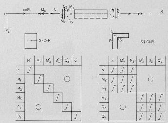
Bild 4. Schemen der Formänderungsintegrale für Stabwerke. Linkes Schema: normale räumliche Rahmen, rechtes Schema: exzentrische Rahmen Legende:
