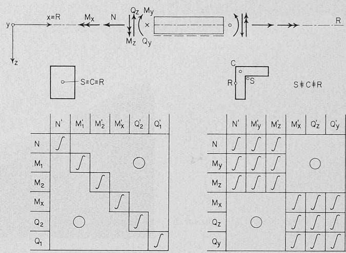
Bild 4. Schemen der Formänderungsintegrale für Stabwerke. Linkes Schema: normale räumliche Rahmen, rechtes Schema: exzentrische Rahmen
