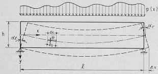
Bild 1. Statisches System mit Bezeichnungen
