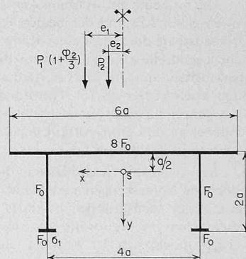
Das Längenmass  $a$  in Bild 3 sei 2,00 m, und die Fahrbahnbreite sei gleich dem Hauptträgerabstand, somit 8 m. Daraus folgt  $e_1/a=1$ ,  $e_2/a=2/5$ . Für  $\varphi_2$  wird ein mittlerer Wert von 20% eingesetzt, was
