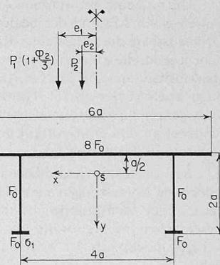
Das Längenmass  $a$  in Bild 3 sei 2,00 m, und die Fahrbahnbreite sei gleich dem Hauptträgerabstand, somit 8 m. Daraus folgt  $e_1/a=1$ ,  $e_2/a=2/5$ . Für  $\varphi_2$  wird ein mittlerer Wert von 20% eingesetzt, was
