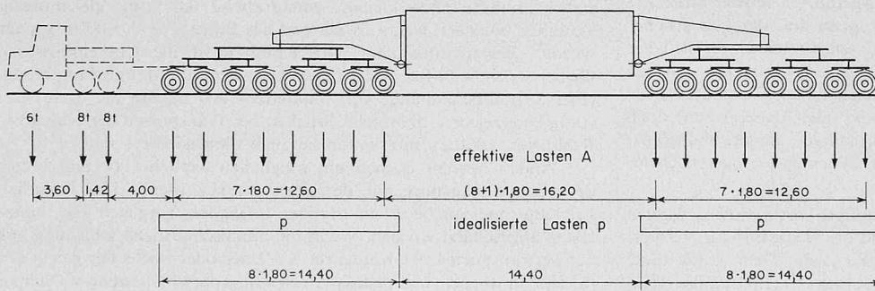
Bild 2. Schema eines Schwertransportes
