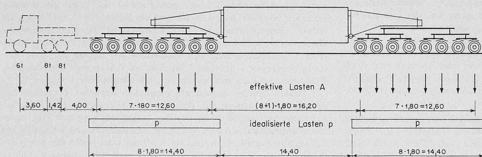
Bild 2. Schema eines Schwertransports
