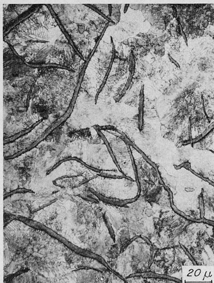
Bild 3. Gusseisen mit Lamellengraphit mit perlitischer Grundmasse (geätzt)
