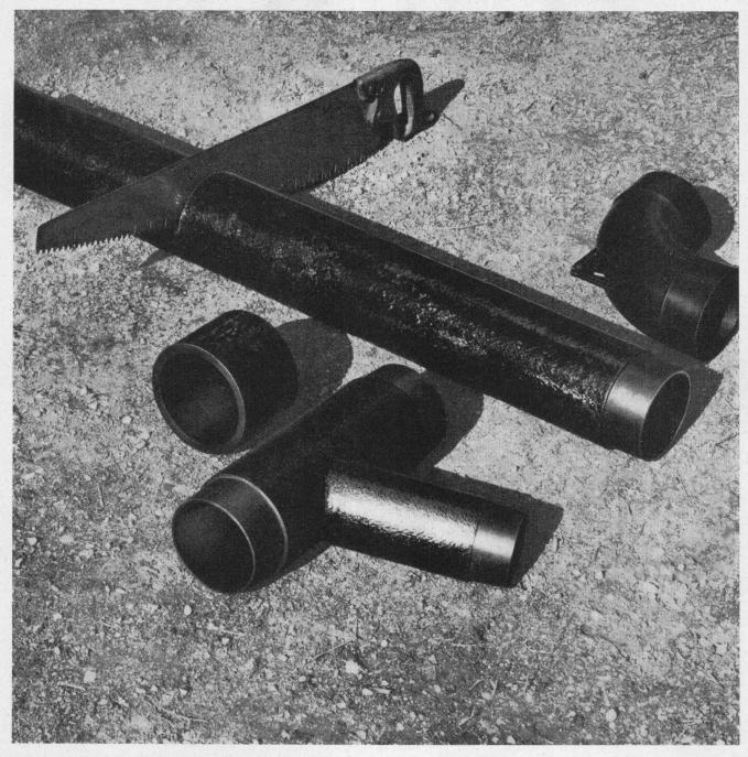
KEY-Rohre gibt es in verschiedenen Normlängen (160—300 cm). Zwischenstücke für den Anschluss längen Sie auf der Baustelle nach Bedarf mit einer Handsäge ab. Das Reststück wird ans nächste Rohr angeschlossen.
