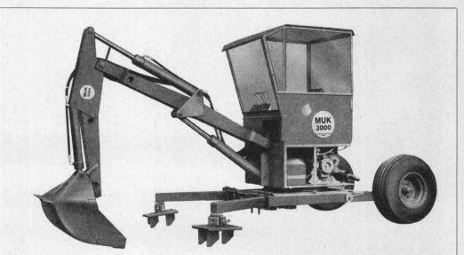
MUK 3000 ist ein absolut neuartiger Bagger, der überall eingesetzt werden kann: im Sumpf, im Morast, am Hang, am Steilhang (auch quer zum Hang), in den Bergen, in Bächen. Er kann Lasten heben, zum Transport selber auf die Lastwagenbrücke «steigen» und kostet dabei viel weniger als ein Bagger der üblichen Bauart.
