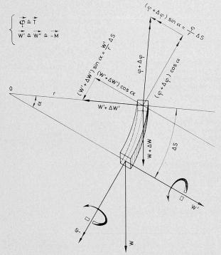
Bild 1. Zusammenhänge der Deformationen am gekrümmten Element
