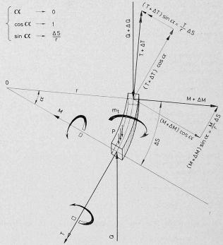
Bild 2. Gleichgewichts-Gleichungen am gekrümmten Element
