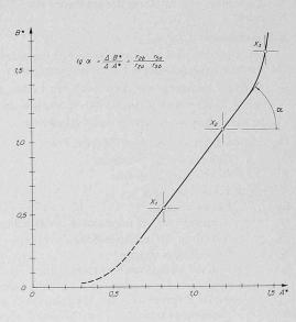
Bild 3. Zuordnungskurve der Leitapparat- und Laufschaufelstellung einer Kaplan-Turbine
