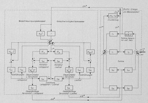
Bild 4. Funktionsschema einer hydroelektrischen Anlage mit Kaplan-Turbine und Regler gemäss Bild 2, im Einzelbetrieb
