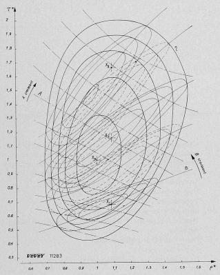
Bild 1. Hydraulische Funktionscharakteristiken einer Kaplan-Turbine
