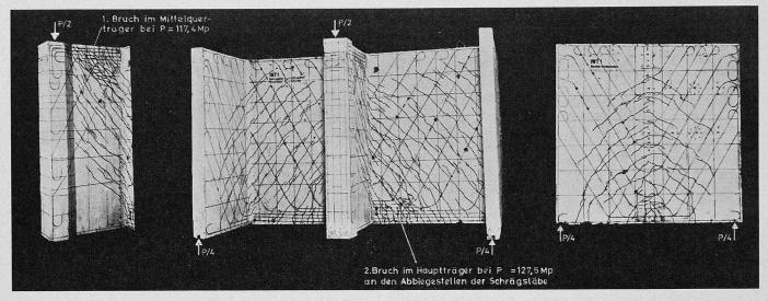
Bild 20. Träger IWT 1 nach dem Bruch bei 127,5 t. Bruchursache: Zerstörung des Betons am Hauptträger an den Abbiegestellen der Schrägstäbe
