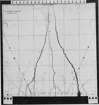
Bild 3. Wandartiger Träger WT 1 ( $\mu=0.134$  %) nach dem Bruch bei  $P_U=97.2$  t. Bruchursache: Ueberschreiten der Zugfestigkeit der Biegezugbewehrung hinter der letzten Abbiegestelle
