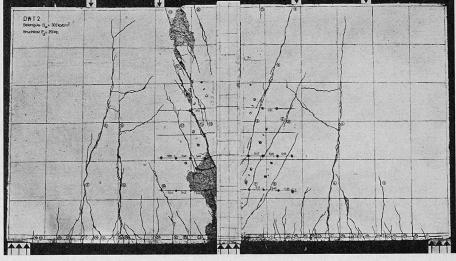
Bild 16. Träger DWT 2 nach dem Bruch bei 4 P $_U=251\,\mathrm{t.}$  Bruchursache: Abscheren des linken Trägerfeldes entlang der Lisene
