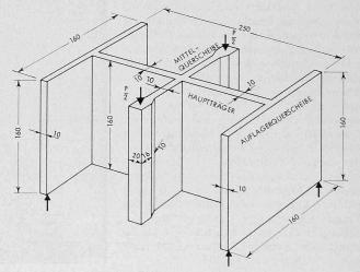
Bild 18. Ausbildung und Abmessungen der indirekt gelagerten und indirekt belasteten wandartigen Träger IWT 1 und IWT 2
