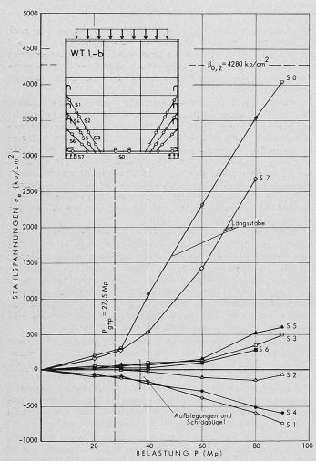
Bild 11. Beanspruchung von Biegezugbewehrung und Schubbewehrung des Trägers WT 1 $-\,\mathrm{b}$
