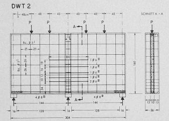
Bild 14. Abmessungen und Bewehrung des durchlaufenden Trägers DWT 2
