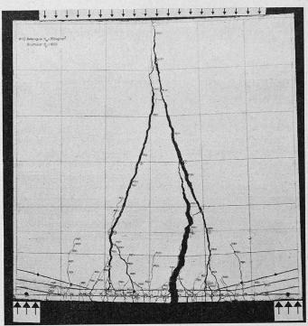
Bild 4. Wandartiger Träger WT 2 ( $\mu=0.134$  %) nach dem Bruch bei  $P_U=119.5$  t. Bruchursache: Ueberschreiten der Zugfestigkeit der Biegezugbewehrung etwa in Trägermitte
