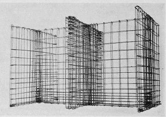
Bild 19. Bewehrungen der Versuchsträger IWT 1 (oben) und IWT 2 (unten) vor dem Einbringen in die Schalung
