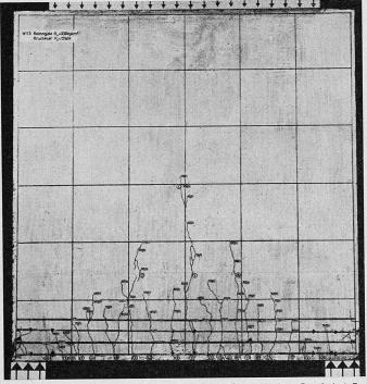
Bild 5. Wandartiger Träger WT 3 ( $\mu=0.268$  %) nach dem Bruch bei  $P_U=129.0$  t, Bruchursache: Versagen der Auflagerzonen bei  $p_a=403$  kp/cm² = 1,33  $\beta_P$
