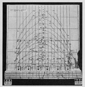
Bild 9. Wandartiger Träger WT 7 ( $\mu=0.268~\%$ ) nach dem Bruch bei  $P_U=117.3~\rm t.$  Bruchursache: Versagen des Betons auf schiefen Druck in der Kämpferzone der Gewölbe
