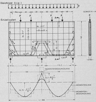
Bild 13. Abmessungen und Bewehrung des durchlaufenden Trägers DWT 1
