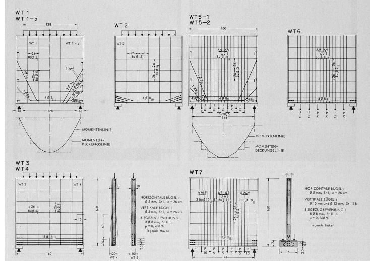
Bild 1. Abmessungen und Bewehrung der Versuchsträger mit Lasteintragung am oberen Rand
