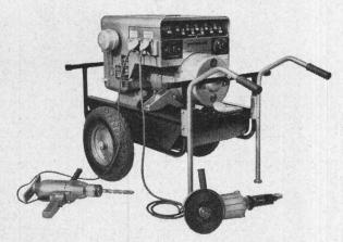
Gleichstrom bis 200 Ampère Wechselstrom 3,5 kW / 220 V
