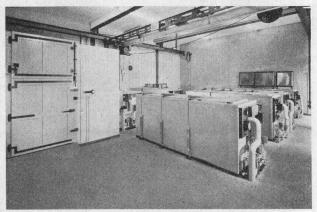
Beton-Frostanlage in der Empa
