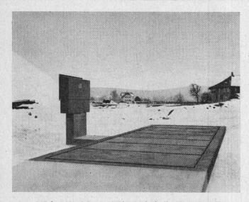
Brücke  $10\times2,8$  m, Laufgewichtsbalken mit parallelgeschaltetem Messkopf
