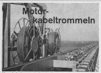
Motorkabeltrommeln Bischoff & Hensel in betriebssicherer und bewährter Ausführung für die Stromzuführung und Steuerung von ortsveränderlichen Stromverbrauchern.
