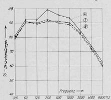
Bild 10. Schallpegelmessungen im Maschinensaal, Nahfeld. Kurve 4: Rohzustand, Gruppe 1 mit 60 MW und Gruppe 3 mit 70 MW in Betrieb. Kurve 5: Boden mit geschliffenen Kunststeinplatten, Decke mit Prodecor-Platten ausgelegt, Gruppe 2 mit 60 MW und Gruppe 3 mit 70 MW in Betrieb, Kurve 6: Fertigzustand, Gruppe 2 mit 65 MW und Gruppe 3 mit 77 MW in Betrieb
