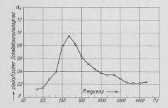
Bild 4. Statistischer Absorptionsgrad in Funktion der Frequenz von Prodecor-Trockenstuckplatten auf 50-mm-Lattenrost
