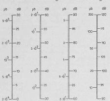
Bild 1. Vergleichsmasstab zwischen Schalldruck in  $\mu$  b (Mikro-Bar) und in dB
