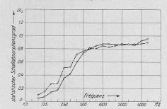
Bild 7. Statistischer Absorptionsgrad in Funktion der Frequenz von AFRA-Spritzasbest 20 mm (ausgezogene Kurve) und 30 mm (unterbrochene Kurve)
