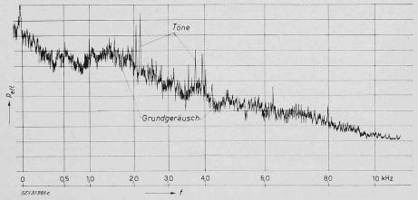
Bild 9. Geräusch einer elektrischen Maschine. Suchtonanalyse nach G. Hübner. P $_{eff}$  effektiver Schalldruck im Bandbreitenbereich 10 Hz, f Fequenz
