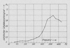
Bild 5. Statistischer Absorptionsgrad in Funktion der Frequenz von Stiflex-Belag direkt auf harter Unterlage
