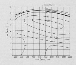
Bild 7. CO-Kennfeld im Abgas des Motors F6L 312
