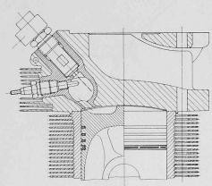
Bild 1. Wirbelkammerbrennraum am Versuchsmotor
