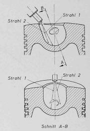
Bild 3. Geneigter, zylindrischer Brennraum mit Lage der Einspritzstrahlen. Die Pfeile geben die Drehrichtung des Wirbels an
