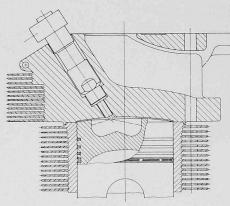
Bild 2. Brennraum mit Kolbenmulde und Direkteinspritzung durch Vierlochdüse
