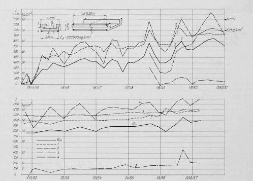
Bild 23. Gemessene Kantenpressungen und totaler Druck im Druckriegel der Landquartbrücke bei Klosters, Messperiode 1944—1957 (VAWE)
