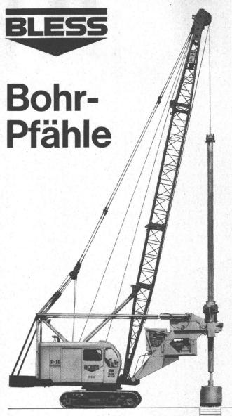
Pfahldurchmesser 80-120 cm Pfahllänge bis 30 m Pfahlfussdurchmesser 240-360 cm Tragkraft pro Pfahl bis 900 t
