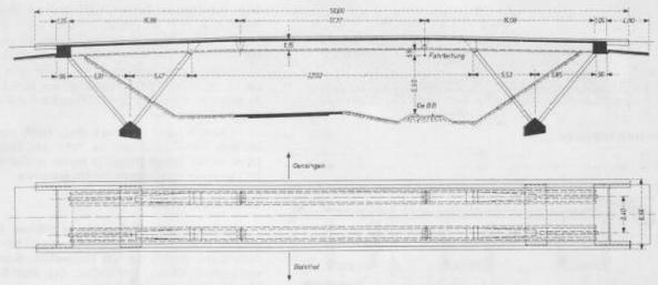
Bild 2. Ueberführung Oensingen, Längsschnitt und Grundriss 1:400
