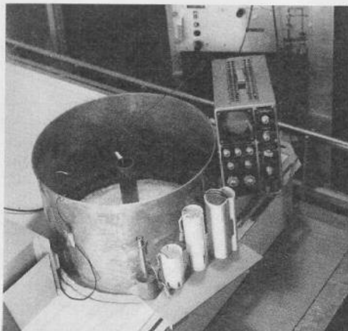
Bild 16. Elektrischer Messtank zur Widerstandsbestimmung an Rohrmodellen
