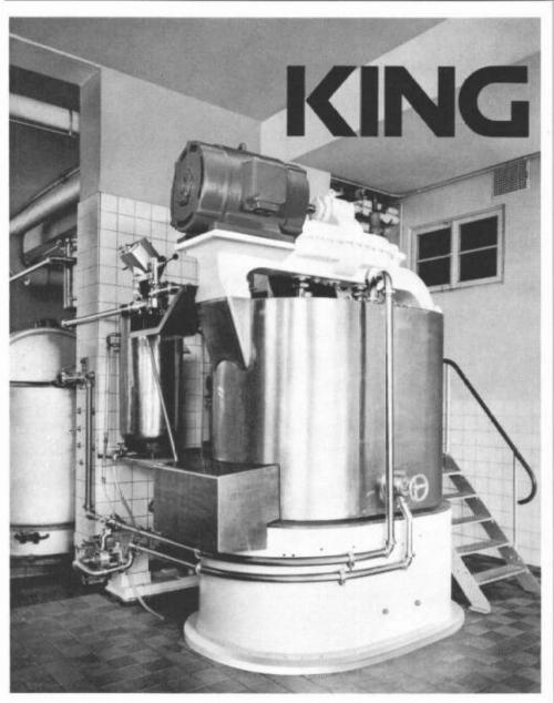
Zwillings-Rührwerk aus Chrom-Nickel-Stahl für Margarine-Herstellung
