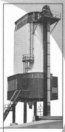
Leistung ca. 80–100 m³/h 4 Sorten Zement à 20 t Inhalt 8 Zuschlagstoffe à 22 m³ Inhalt 1 Zwangsmischer, 2600 t Inhalt Elektronische Steuerung mit Lieferschein-Druckwerk Beschickung der Anlage durch Elevator G 100 mit 100 m³/h
