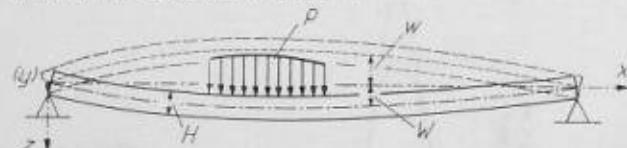
Supposons que la plaque en question possède avant l'application de la charge une certaine courbure, donnée par une fonction  $w$  définissant la surface moyenne initiale (Fig.). Pour la flexion d'une telle coque de faible courbure on a en coordonnées cartésiennes  $x$ ,  $y$  les équations différentielles suivantes, données par Marguerre [2]:
