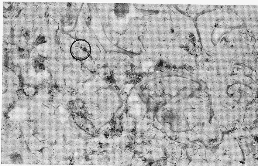
Bild 7. Geschliffene Oberfläche einer Platte aus einem an Spiralschnecken-Trümmern reichen Kalkstein des mittleren Malms. Die zahlreichen schwarzen Punkte sind verwitterte, rostbraun verfärbte Pyritkristalle. Die Fleckenbildung ist in der Detailaufnahme der mit einem Kreis markierten Stelle deutlicher erkennbar (Bild 8)
