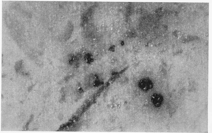
Bild 8. Detailaufnahme aus derselben Gesteinsplatte wie im Bild 7 (Kreismarkierung), in rd. 25facher Vergrößerung. Erkennbar sind die Farbhöfe um die Pyritkristalle und die diffuse bis schlierige Fleckenbildung
