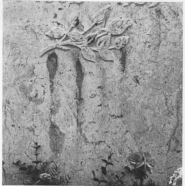
Bild 10. Fleckenbildungen ausgehend von starken Pyritanhäufungen an einem Grabstein aus Jurakalkstein
